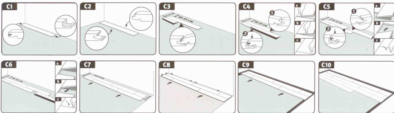
**ВНИМАНИЕ!** При укладке торцевые стыки панелей каждого последующего ряда должны быть смещены минимум на 200 мм относительно стыков панелей предыдущего ряда. **Внимание:** При укладке длинных панелей (2052 мм x 248 мм) смещение стыков должно составлять минимум 500 мм. Укладывая покрытия с заводской фаской и/или особым декором (например, имитирующим плитку), необходимо следить, чтобы смещение было равномерным и соответствовало фаске и/или рисунку.
